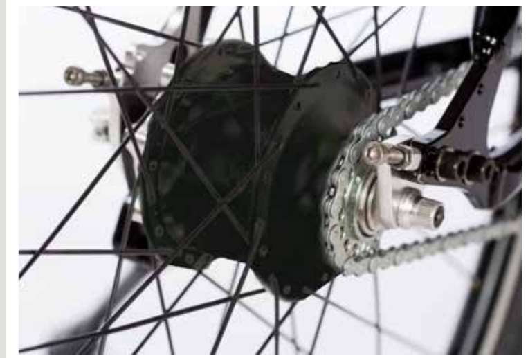
De Rohloff naaf met 14v heeft net zoveel mogelijkheden als een 27v derailleur systeem. Het grote voordeel van een Rohloff naaf ten opzichte van een derailleur systeem is, dat de Rohloff naaf weinig onderhoud nodig heeft. 1x per jaar olie verversen volstaat. Totaalbereik 526%
