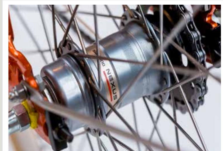
De 3v naaf van Shimano is erg veel gebruikt. Het is de basis waarbij de 1e versnelling gebruikt kan worden om snel weg te fietsen bij de verkeerslichten. Standaard fiets je veel in de 2e versnelling en berg af, wind mee zal de 3e versnelling aan de orde komen. Het is dus iets minder zoeken naar de juiste versnelling. Totaal bereik: 177%
