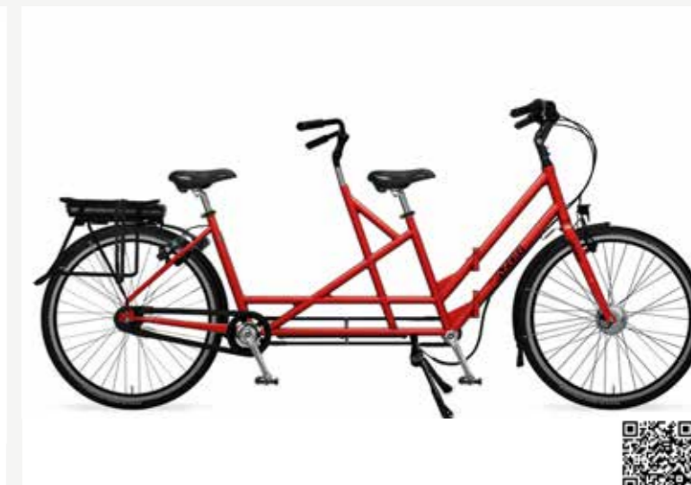
Freewheel crankstel: Het optionele freewheel crankstel geeft de mogelijkheid om onafhankelijk van elkaar te trappen.
