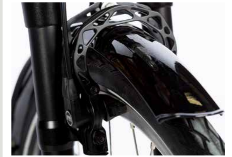
De hydraulische velgremmen van Magura vergen iets meer onderhoud dan de rollerbrakes maar hebben een ongekende remkracht.
