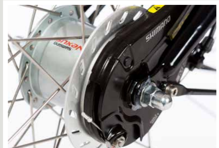
Remmen: Azor kiest voor veel modellen de onderhoudsarme rollerbrake remmen van Shimano. Sommige modellen hebben de BR-C6000, deze hebben een grotere koelschijf en een nog betere remwerking.
