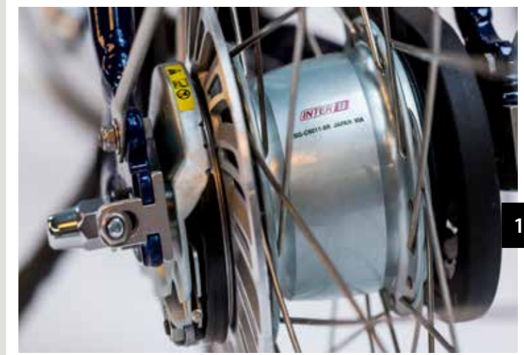
De 8v Premium naaf van Shimano is bijzonder omdat de tandwielen in de naaf van naaldlagers zijn voorzien. Dit maakt de naaf lichtlopender dan de standaard 8v. Azor gebruikt alleen nog Premium 8 naven (m.u.v. R8). Totaal bereik van 307%
