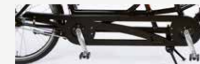
Freewheel crankstel: Het optionele freewheel crankstel geeft de mogelijkheid om onafhankelijk van elkaar te trappen.
