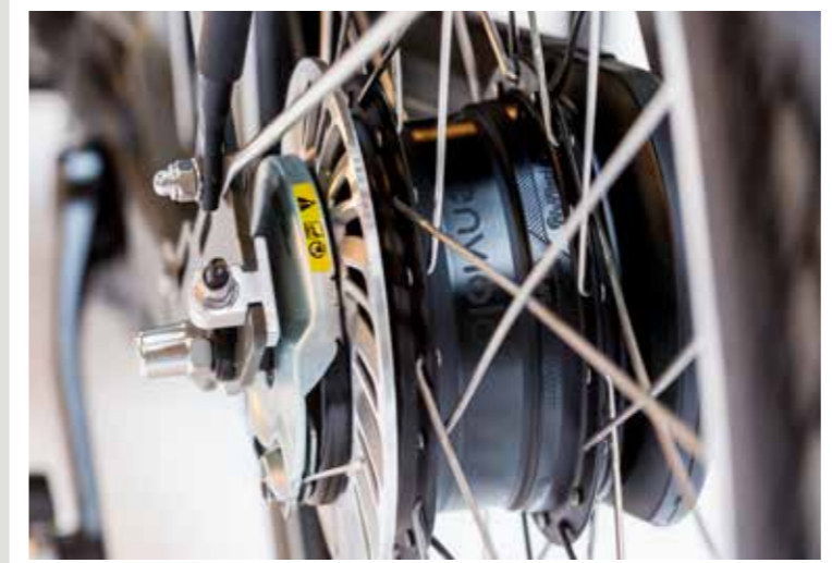
De Enviolo naaf is uniek in zijn ontwerp. Door zijn speciale constructie heeft deze naaf geen standen maar is hij traploos te verstellen. Dus altijd de juiste versnelling. Totaal bereik 380 %
