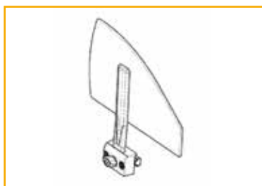
Zijschotten. Gemonteerd aan de zitrail. Breedte: 235 mm Hoogte: 145 mm Hoogte-instelbereik: 190-215 mm (zitplaat tot hoogste punt)
