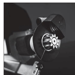
Passage du mode manuel en mode électrique en embrayant ou débrayant les pignons des moteurs.
