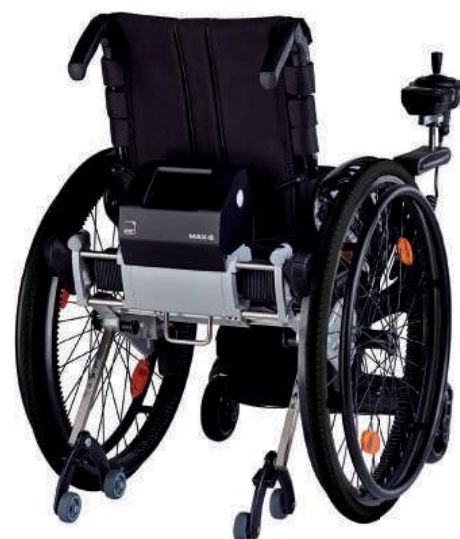
Passage du mode manuel en mode électrique en embrayant ou débrayant les pignons des moteurs.
