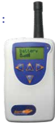
AIP137CAAB Bieper met 8 kanalen AIP137BAAB Bieper met 64 kanalen
