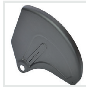
Spatbord met plaat, geheel uit koolstof
