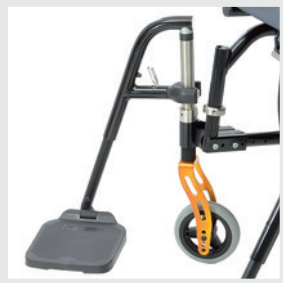
ULM-systeem, voor hemiplegie, de richting van de rolstoel wordt geregeld via de voetplaat die verbonden is met de as van de vork
