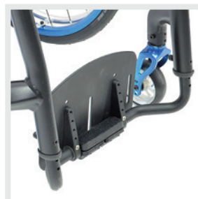
Eendelige terugklapbare aluminium voetplaat, in hoek en diepte verstelbaar
