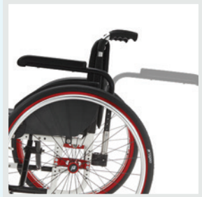
Buisvormige armsteunen, in hoogte verstelbaar, wegklapbaar, afneembaar, met stalen steun en veiligheidsvergrendeling
