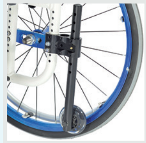
Wielen voor smalle doorgangen, afneembaar
