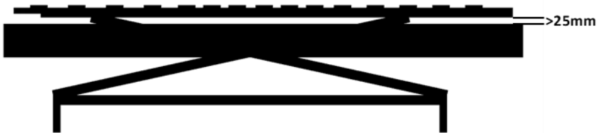
Afbeelding 2: Als de minimale afstand tussen bedgestel en bedframe niet kan worden gerespecteerd, mag het ligvlak niet in het bedframe worden verzonken en mag het slechts zo ver naar beneden worden gelaten dat er tussen de bovenkant van het bedframe en de onderkant van het bedgestel een afstand van minstens 25 mm (= 2,5 cm) is.
