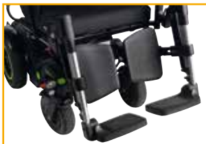
Kuitsteunen, PU, diepte instelbaar Breedte: 180 mm Hoogte: 230 mm Diepte: 35 mm
