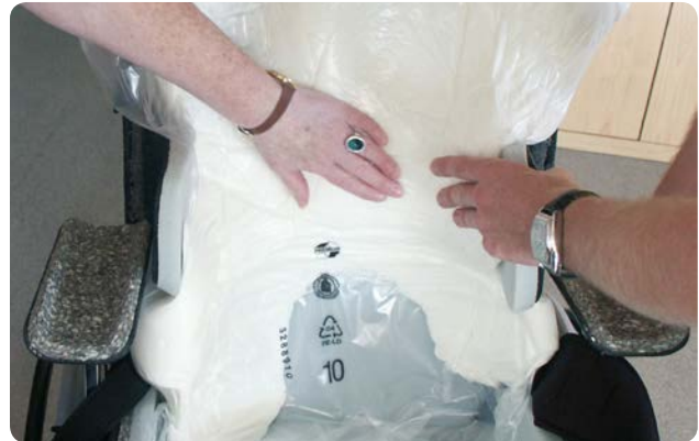
Schaumabdrücke gewährleisten optimale Passgenauigkeit Foam prints ensure an optimum fit
