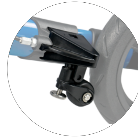
Rolweerstandsysteem (RWS) dat onder de anti stootrand is aangebracht.
