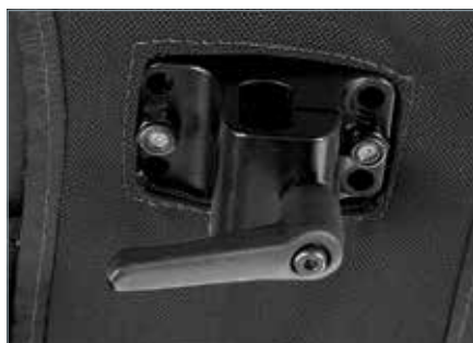
Standaard bevestigingsklem voor de hoofdsteunhouder.
