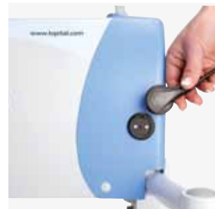
Oplaadpunt met magneetkoppeling.
